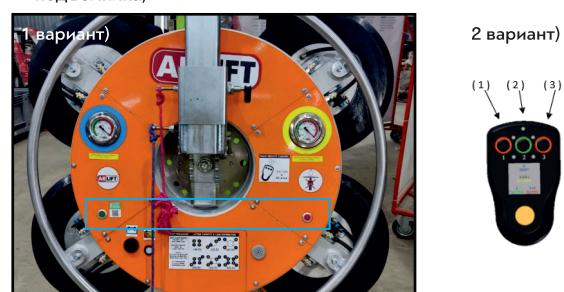
2 вариант) ввести код безопасности, нажимая последовательно кнопки красную «отрыв» (1) - зеленую «захват» (2) - красную «отрыв» (3). Далее в течении 5 секунд зажмите красные кнопки «отрыв» «отрыв» (1) и (3).
